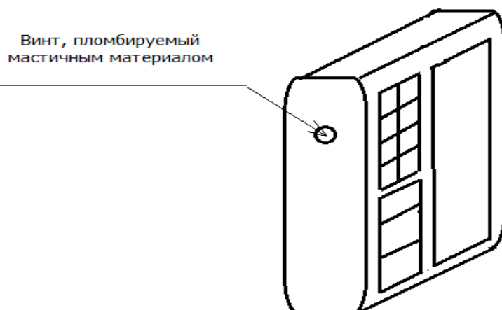
Рисунок 2 Место пломбирования от несанкционированного доступа в торцевой панели.
