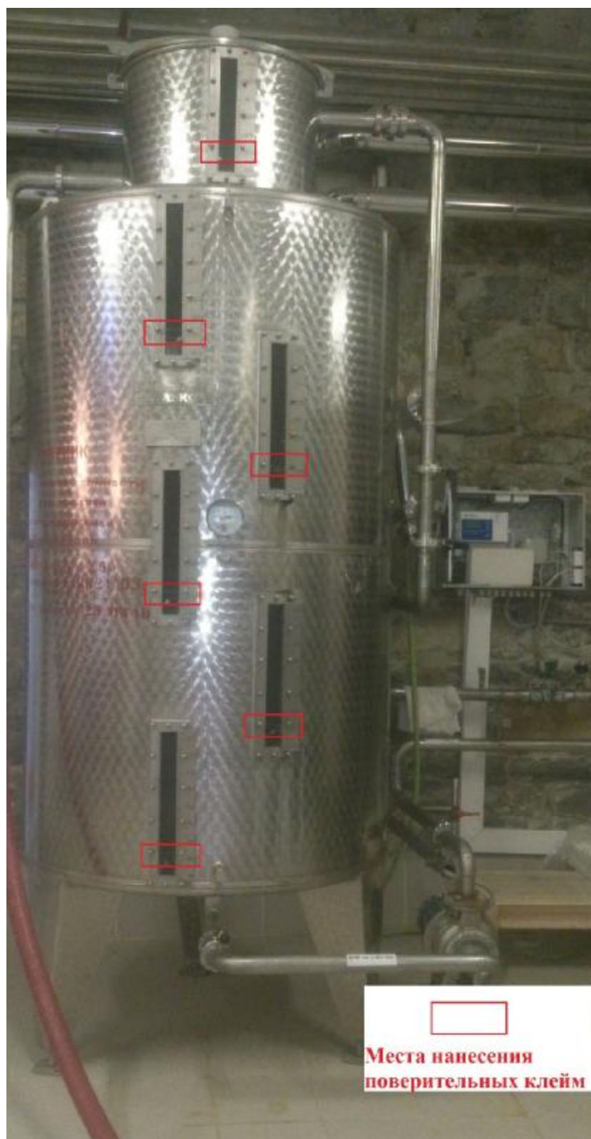
Рисунок 2. Места нанесения поверительных клейм
