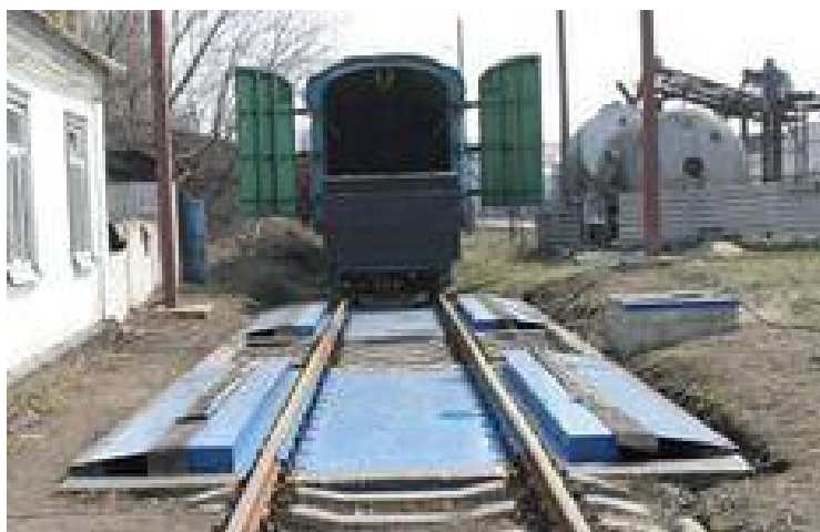
Рисунок 1 – Общий вид весов ОПТИМУМ-В
