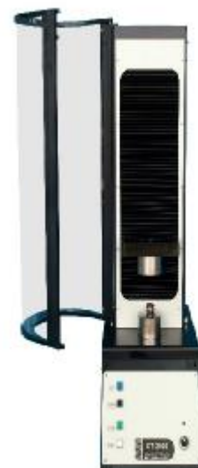
Рис. 3 Машина СТ (диапазон измерений от 1000Н до 5000Н)
