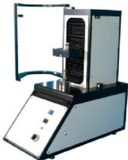
Рис. 2 Машина СТ (диапазон измерений до 500 Н)
