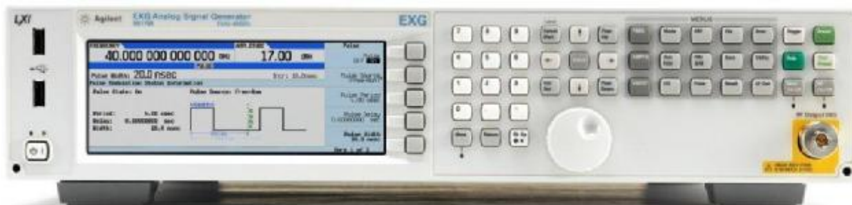
Рисунок 1 - Внешний вид лицевой панели генератора сигналов N5173B
