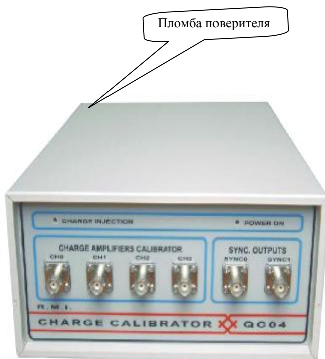
Рис 5. QC04 - мобильное устройство калибровки заряда.
