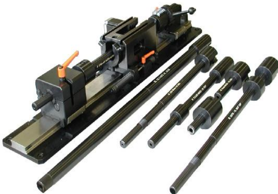
Рис 1. Баллистический затвор UZ-2002 и измерительные баллистические стволы.
