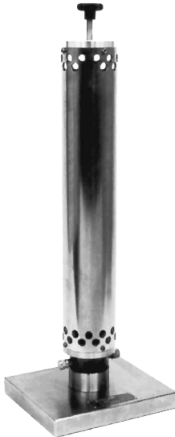
Рис 6. Kistler 6909 - генератор импульса давления.
