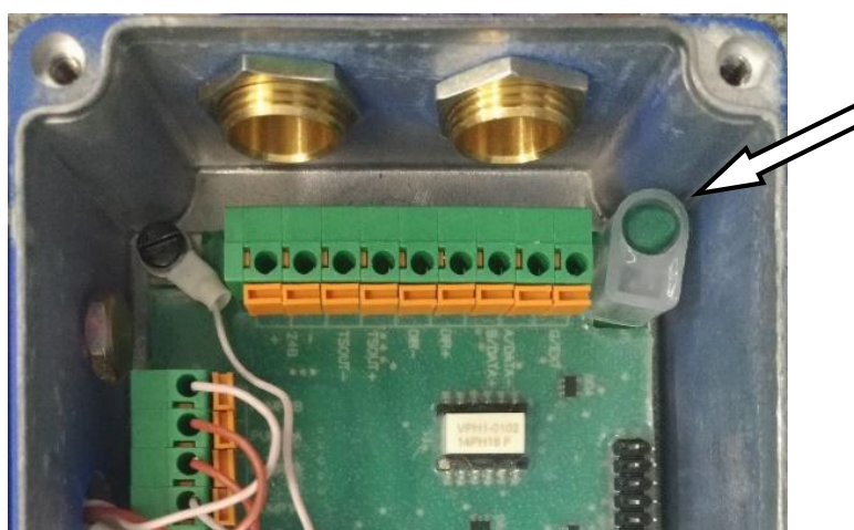
Рисунок 2 – Схема пломбировки от несанкционированного доступа, обозначение места нанесения знака поверки расходомеров-счетчиков электромагнитных «ВЗЛЕТ ППД» исполнений ППД-113, ППД-113*, ППД-213, ППД-Ех
