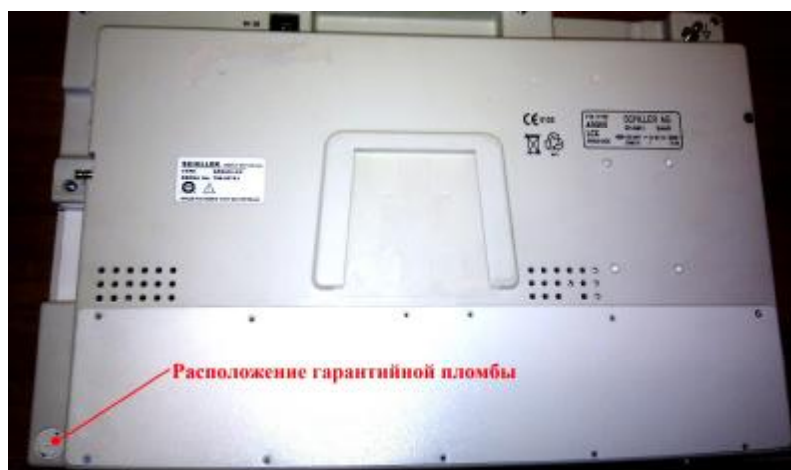
Рисунок 4 – Схема пломбировки монитора пациента ARGUS LCX
