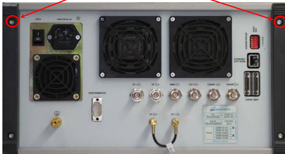
Рисунок 2 – Схема пломбировки от несанкционированного доступа анализатора спектра СК4М-18 (задняя панель)
