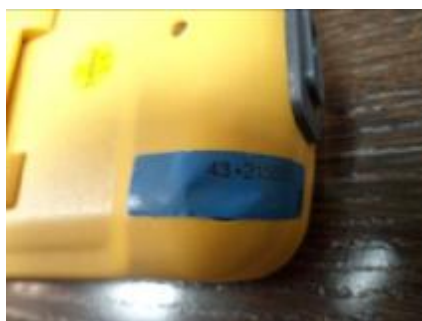
Рисунок 2. Фотография пломбирования мультиметров цифровых серии VA2
