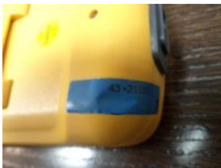
Рисунок 2. Фотография пломбирования мультиметров цифровых серии VA1
