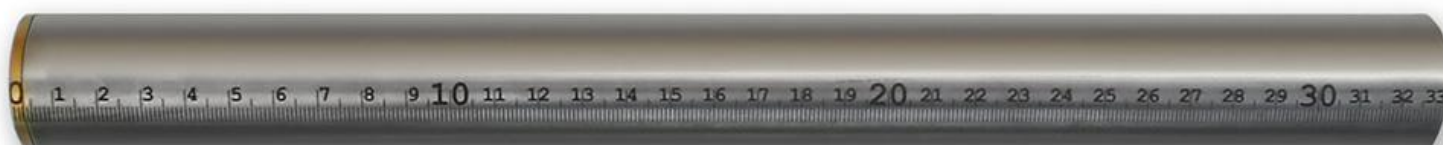
Рисунок 5 – Вид груза из нержавеющей стали с градуировкой.
