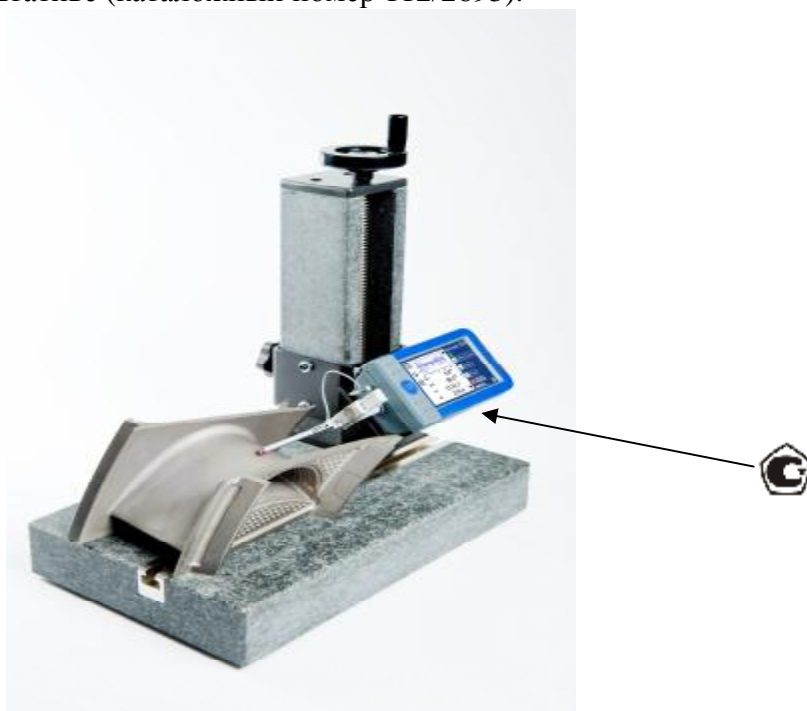
Рисунок 1 - Общий вид прибора для измерений шероховатости поверхности SURTRONIC серии S и места нанесения знака утверждения типа
