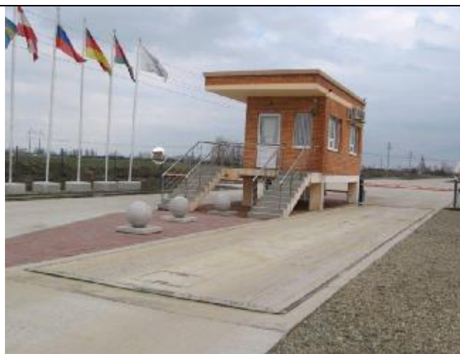
Б) Вариант установки в приямок. Модификация ВАТП 80-18-2-Н-2
