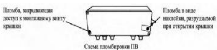
Рисунок 3 — Варианты схемы пломбировки ПВ
