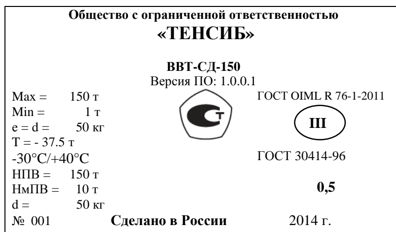
Рисунок 4 — Маркировка весов на грузоприемном устройстве и ПТК
