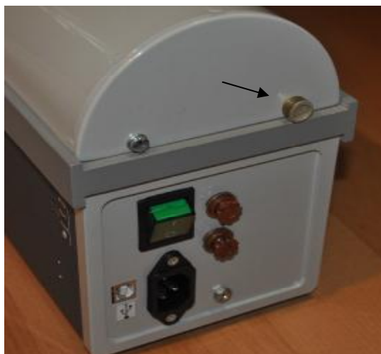
Рисунок 2 - Схема пломбирования крышки установок поверочных «ГВП Фантом-Спиро М»
