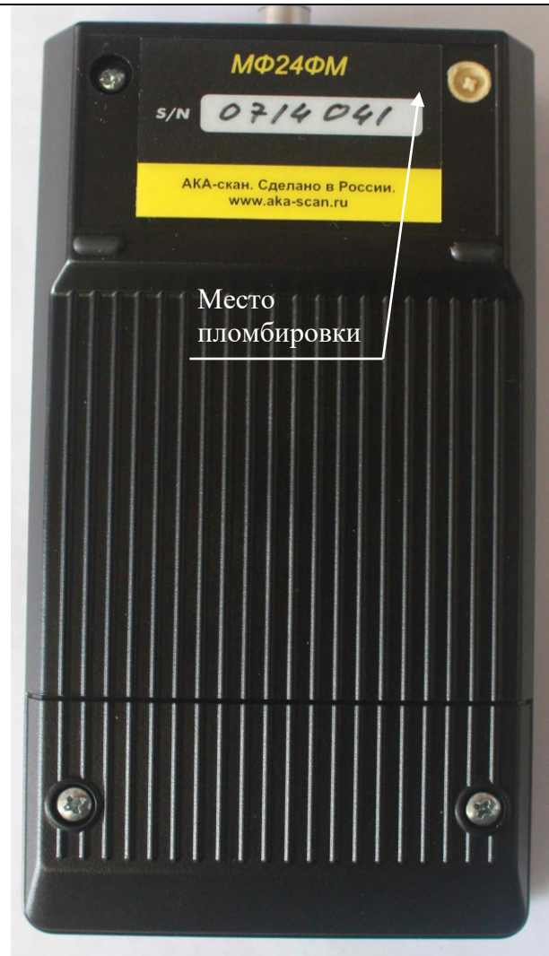
Рисунок 1 – Фотография общего вида магнитометра исполнения МФ-24ФМ и схема пломбировки от несанкционированного доступа
