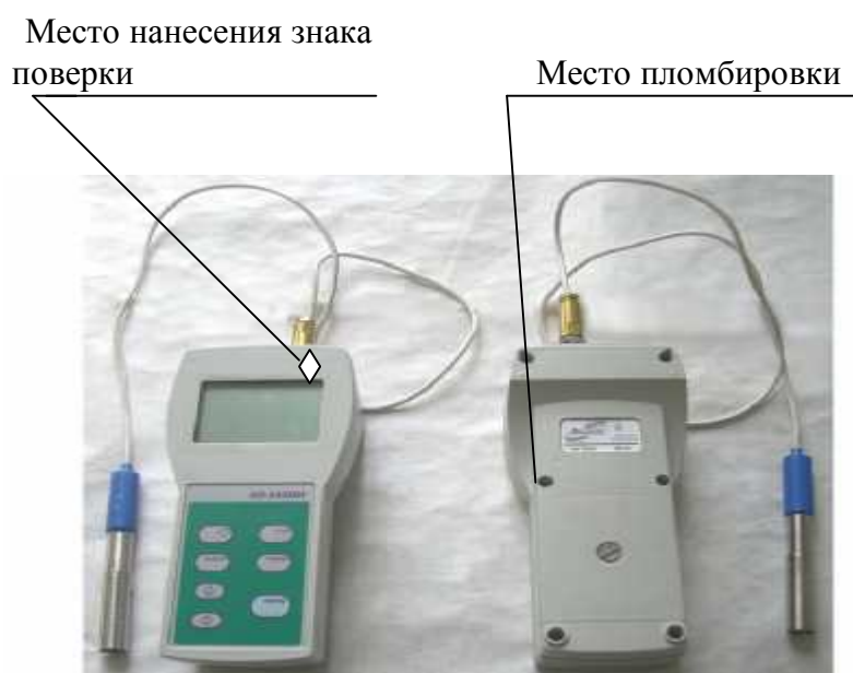
Рисунок 2 - Схема пломбировки для защиты от несанкционированного доступа, обозначения места нанесения знака поверки
