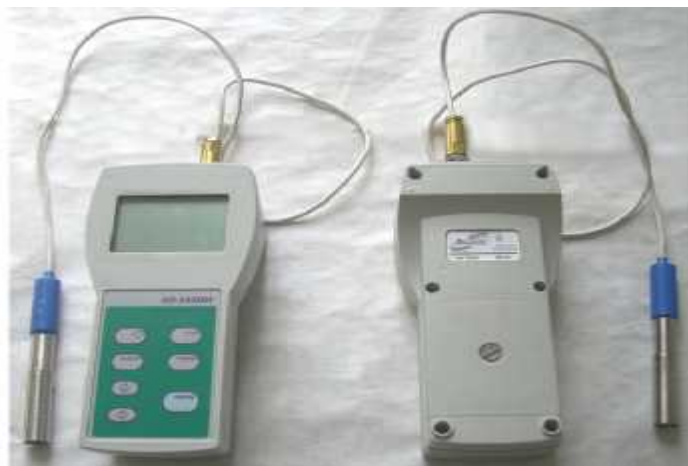
Рисунок 1 - Внешний вид кондуктометров портативных КП-150МИ
