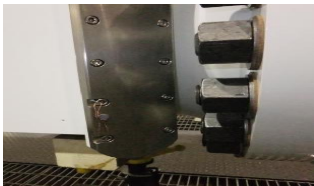
Рисунок 2 – Места пломбировки блоков ПАП на корпусе расходомера ультразвукового LEFM 280Ci
