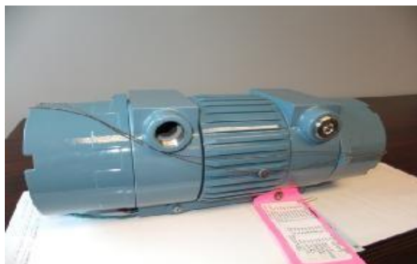
Рисунок 3 – Место пломбировки трансмиттера расходомера ультразвукового LEFM 280Ci
