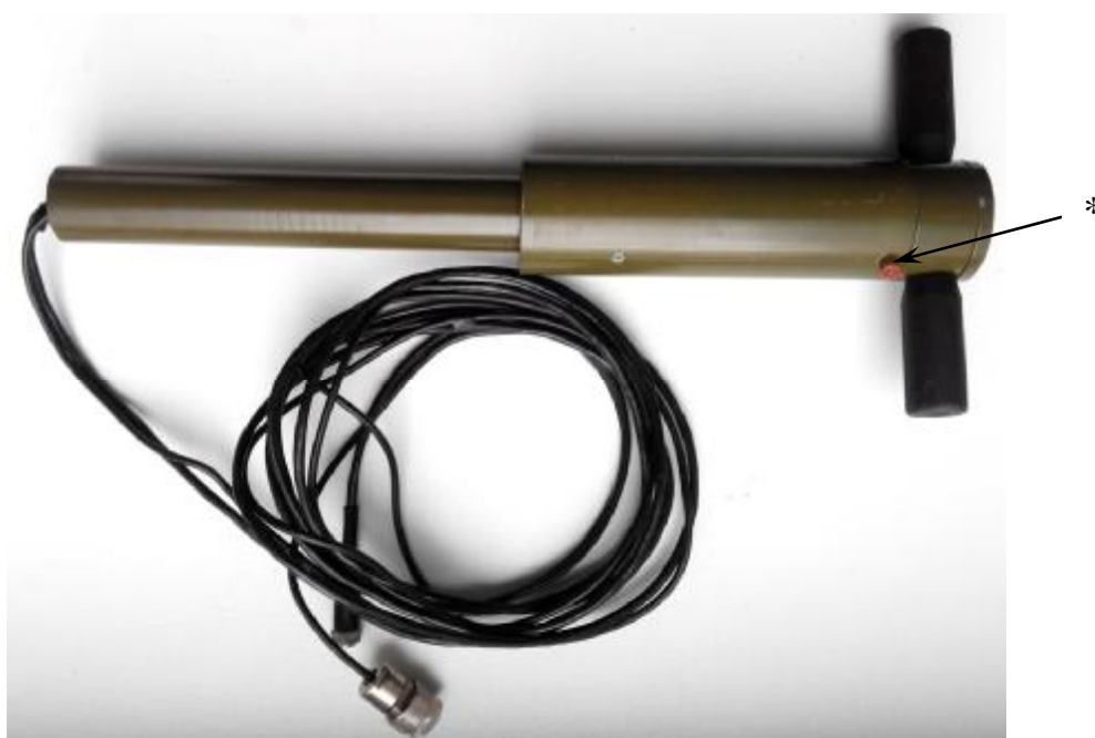
Рисунок 1 - Внешний вид антенны измерительной АИ-1 * - место пломбировки от несанкционированного доступа
