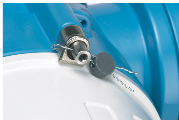
Рисунок 2 - Пломбирование корпуса измерительного преобразователя.
