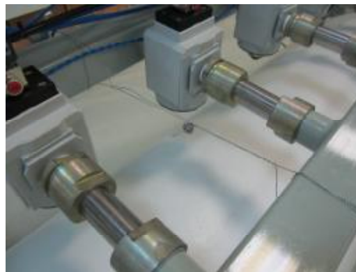
Рисунок 2 - Схема пломбирования установки поверочной для счетчиков газа УПКСГ-10.
