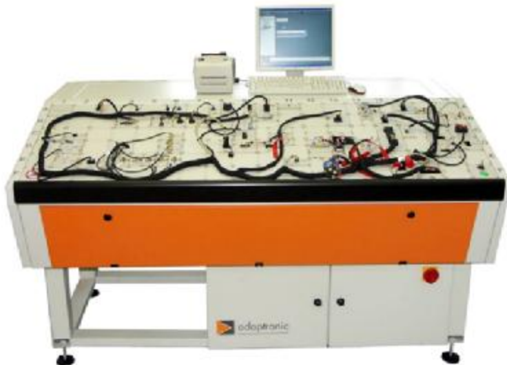
Рисунок 4 - Общий вид системы, смонтированной в тестовый стол TT1800
