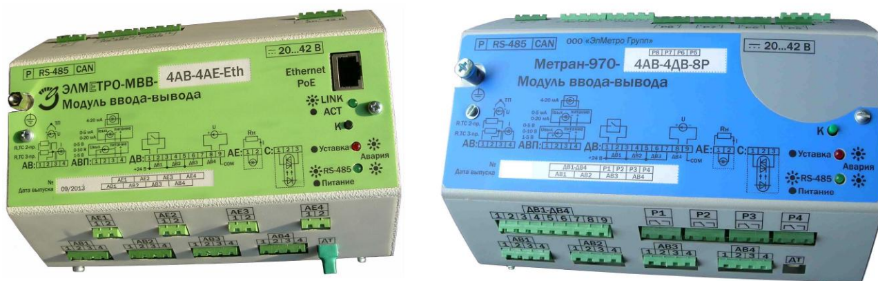
Рисунок 1 - Общий вид модулей ввода-вывода ЭЛМЕТРО-МВВ, Метран-970
