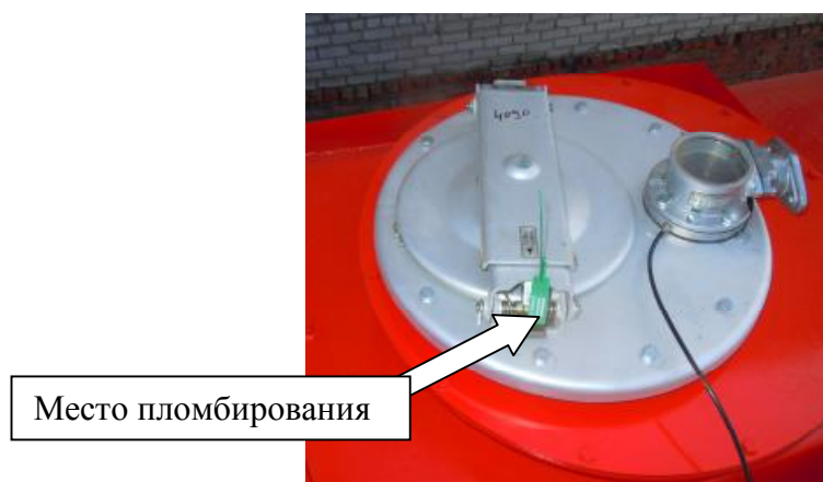
Рисунок 2 - Запорный механизм крышки заливной горловины АТЗ
