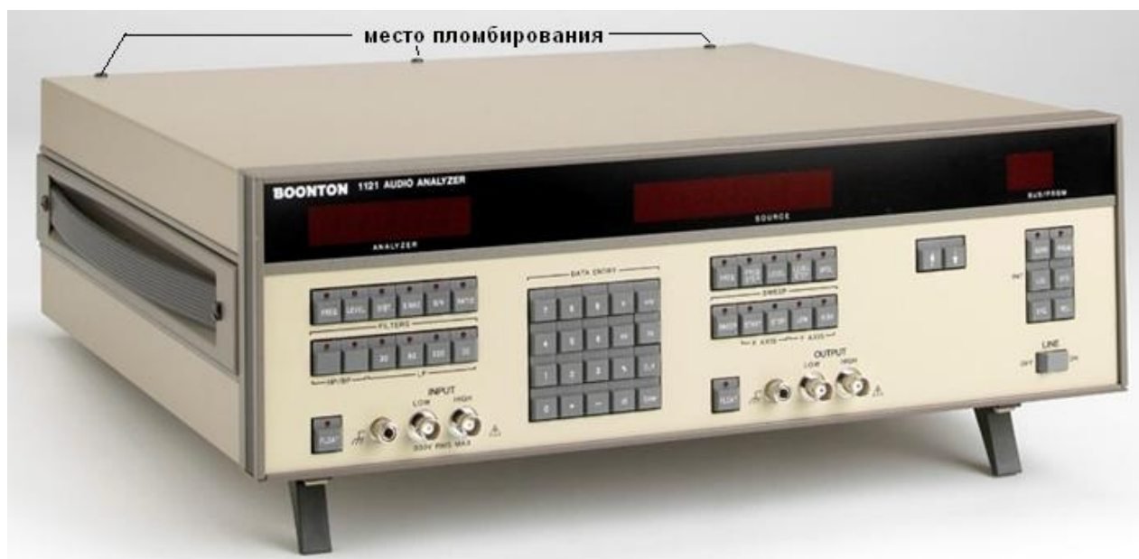
Рисунок 1 – Внешний вид и места опломбирования измерителей
