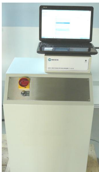
Рисунок 2 – Систем с измерительным каналом воспроизведения избыточного давления
