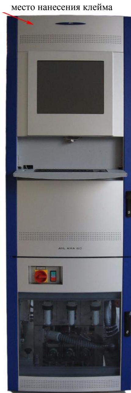
Рисунок 1 - Внешний вид газоанализатора
