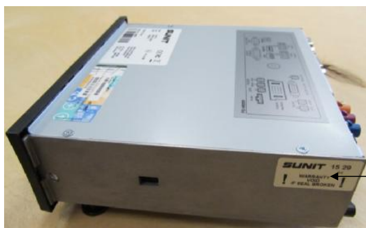
Рисунок 3– Схема пломбировки от несанкционированного доступа контроллера промышленного SunitFD2
