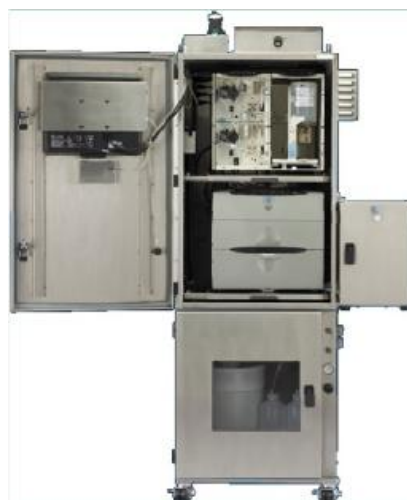
Рисунок 6 - Пример расположения хромато- графа ICS-5000/ICS-5000 + в защитном ко- жухе «Integral»
