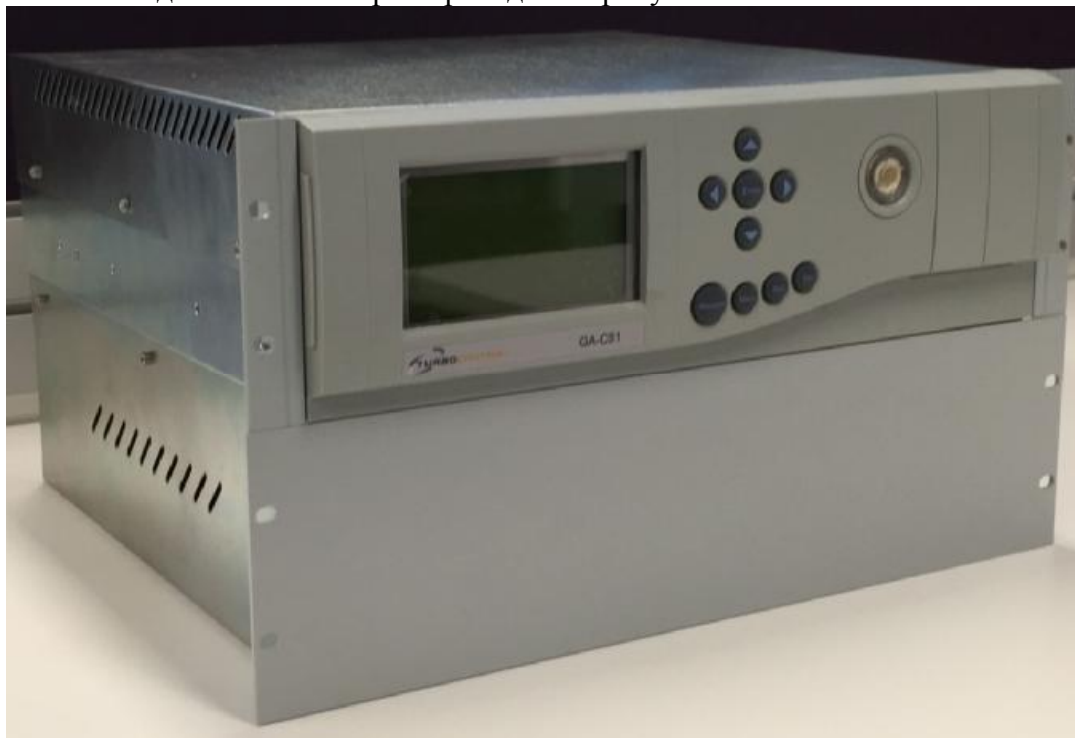
Рисунок 1 – Газоанализатор серии GA модели GA-C51, исполнение для монтажа в стойку (на рисунке исполнение в корпусе 19”, высота 8 монтажных единиц установки)
