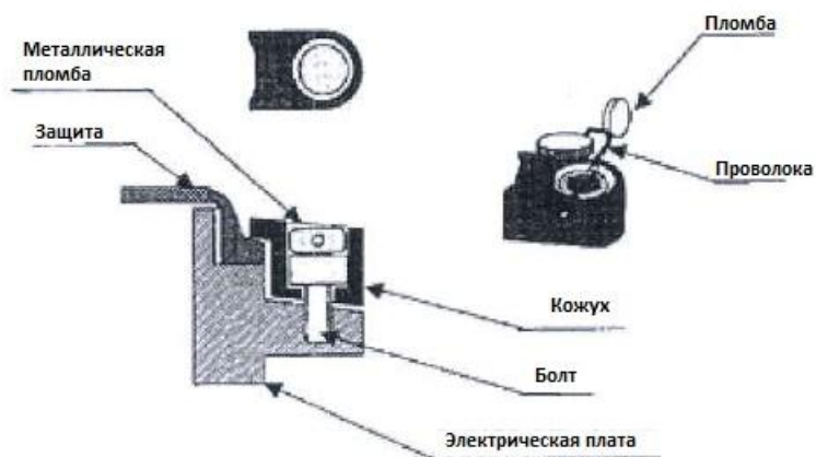
Рисунок 2 - Ограничение доступа к электрическим частям систем
