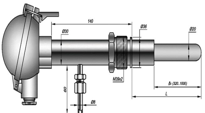
Рисунок 1 – Датчики температуры ТППТ, ТПРТ, ТПВР, ТППТ Ex, ТПРТ Ex
