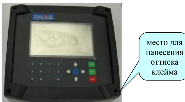
Рисунок 3 – Схема защиты от несанкционированного доступа в настройки индикатора ВУ-2010С и обозначение места для нанесения оттиска клейма - на индикаторе СИ-6000А переключение в режим «калибровка» происходит с помощью переключателя на лицевой панели корпуса. Доступ к переключателю ограничен крышкой и опломбирован (Рисунок 4).
