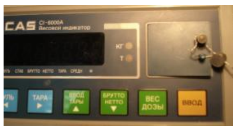
Рисунок 4 – Схема защиты от несанкционированного доступа в настройки индикатора СИ-6000А и обозначение места для нанесения оттиска клейма
