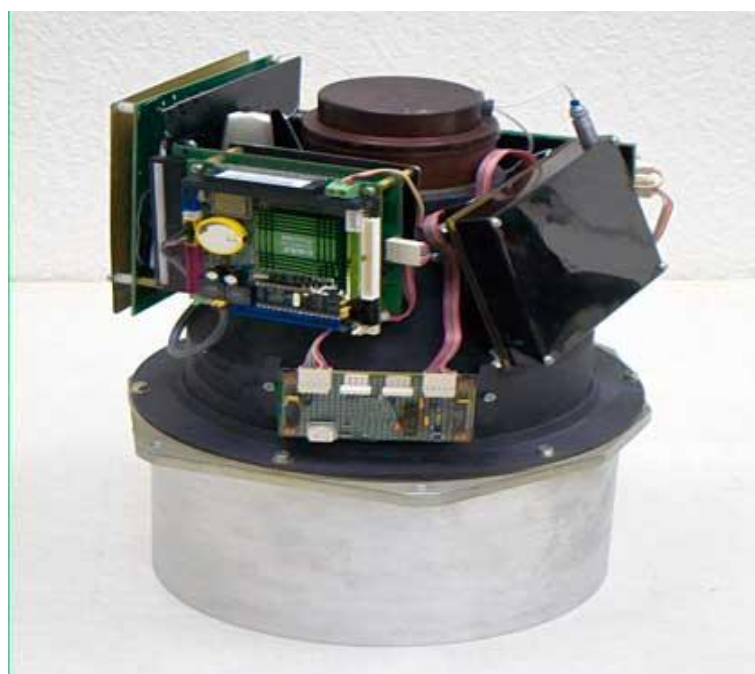
Рисунок 3 - Блоки детектирования комплекса NaI ПАК-0-63В63/3М и NaI ПАК-0-СДН.30.63.63
