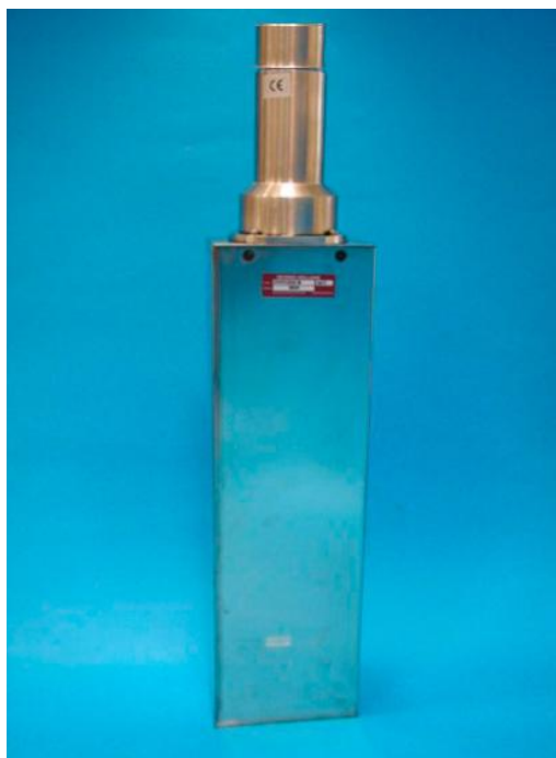
Рисунок 6 - Внешний вид блока детектирования комплекса NaI ПАК-0-R76*127AS406/3М с цифровым спектрометрическим процессором ЦСУ-ПН-02
