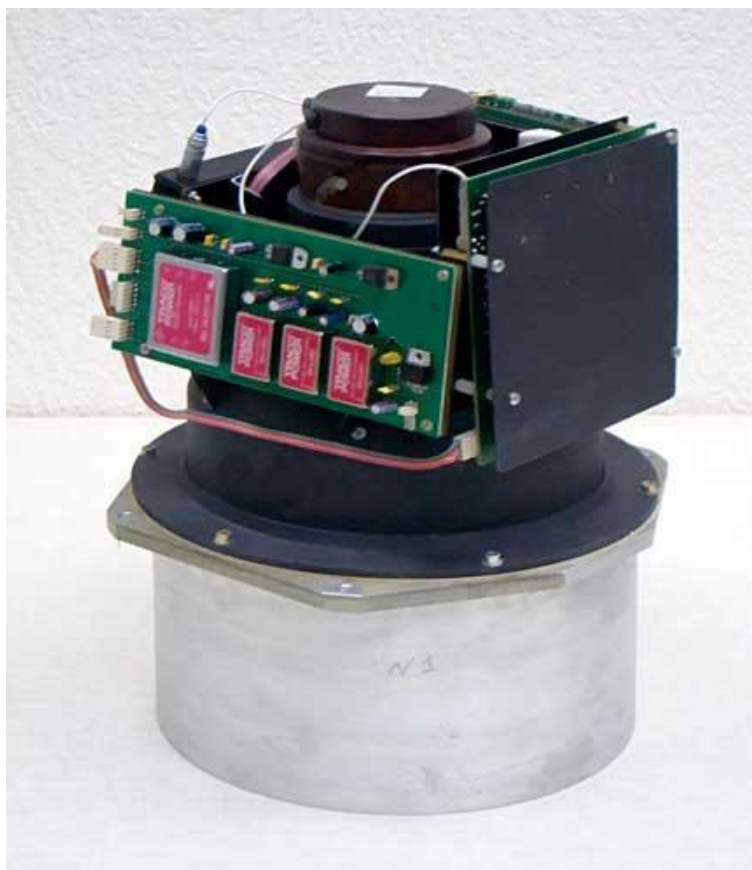
Рисунок 5 - Внешний вид блока детектирования комплекса NaI ПАК-0-СДН.30.200.100 с установленными на время лабораторных испытаний вспомогательными устройствами Детектор NaI(Tl) Ø 200 мм х 100 мм находится в защитном кожухе. Процессор ЦСУ-ПН-02 закрыт дополнительной крышкой.
