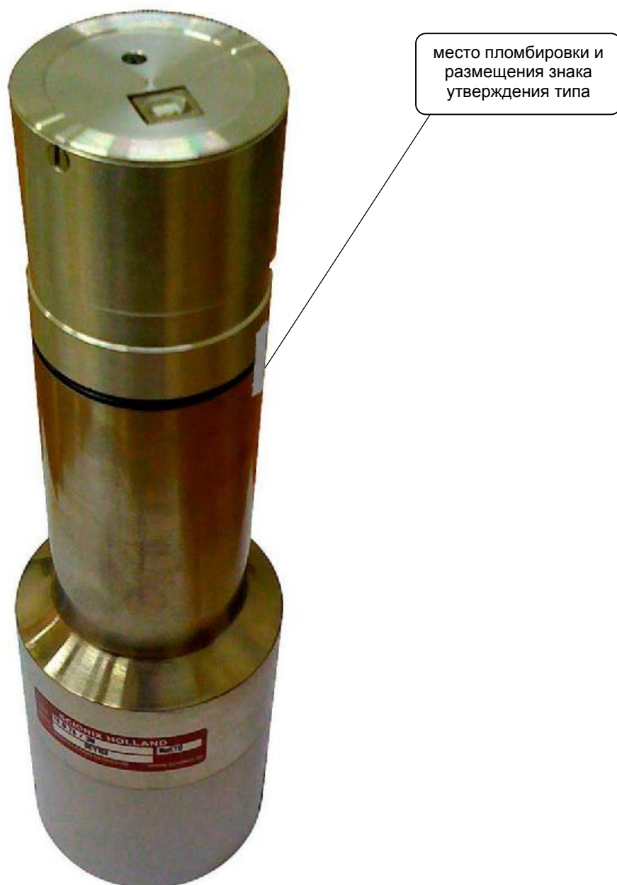
Рисунок 2 - Блок детектирования комплекса NaI ПАК-0-76В76/3М с детектором NaI(Tl) 76В76/3М размером \varnothing 76 мм x 76 мм и цифровым спектрометрическим процессором ЦСУ-ПН-02
