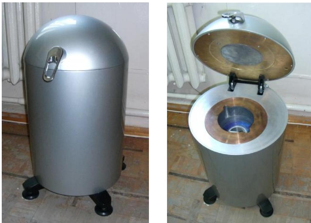
Рисунок 7 - Внешний вид комплексов NaI ПАК-1-76В64/3М-LB, NaI ПАК-1-76В76/3М и NaI ПАК-1-СДН.30.63.63 с детекторами 76В64/3М-LB, 76В76/3М и СДН.30.63.63 соответственно. Низкофоновая защитная камера НЗК-01 комплекса показана с закрытой и открытой крышкой. Управляющий компьютер не показан.
