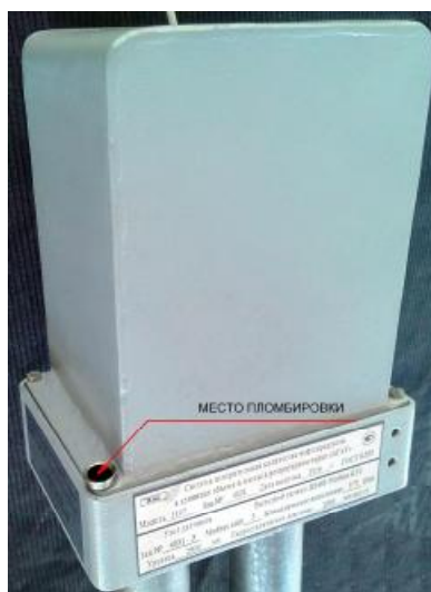
Рисунок 1 - Схема пломбирования системы «АГАТ»
