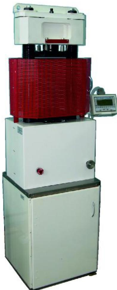
Рисунок 1 - Внешний вид пресса гидравлического измерительного ПГИ-1000С
