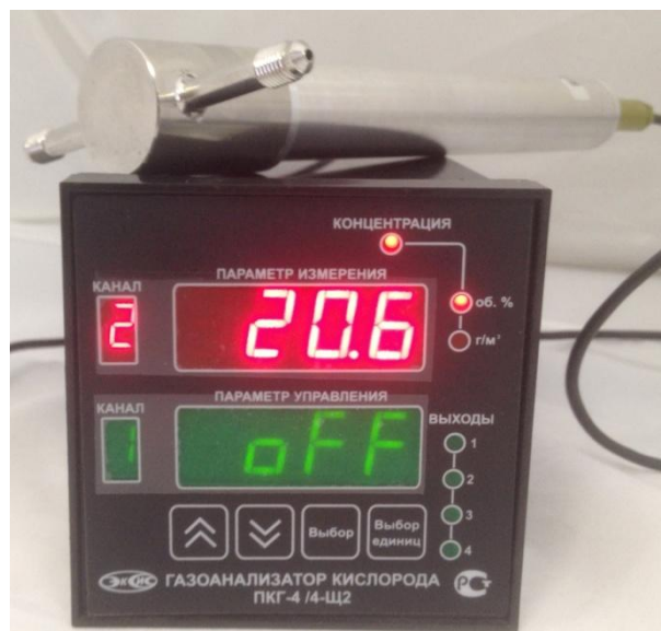
б) исполнение ПКГ-4/4-Щ2-K-4P (четырёхканальный, на фото показан только один измерительный преобразователь)
