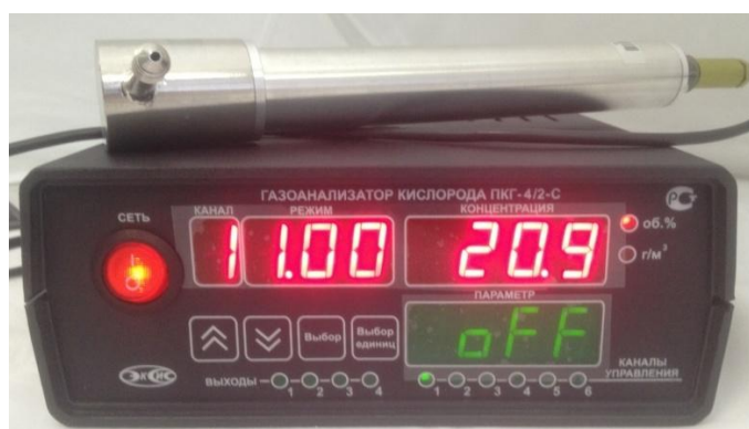
в) исполнение ПКГ-4/2-С-K-4P-2A (двухканальный, на фото показан только один измерительный преобразователь)
