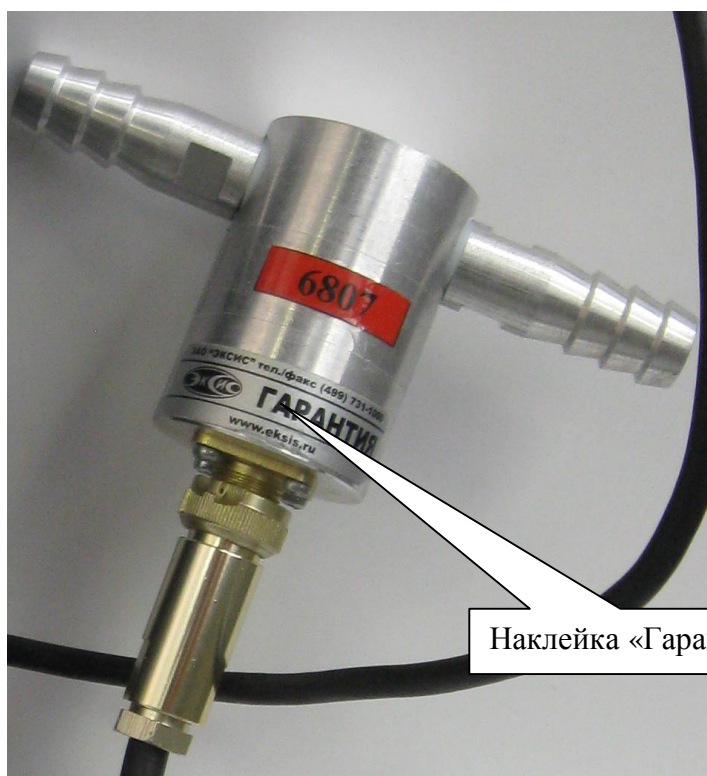
Рисунок 5 – Схема пломбировки выносного измерительного преобразователя
