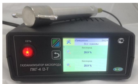
г) исполнение ПКГ-4/2-Т-K-4P-2A (двухканальный, на фото показан только один измерительный преобразователь)
