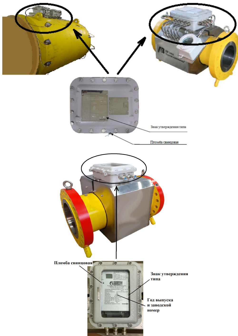
Р и с у н о к 2 – Схема пломбирования расходомеров-счетчиков газа ультразвуковых УВИР
