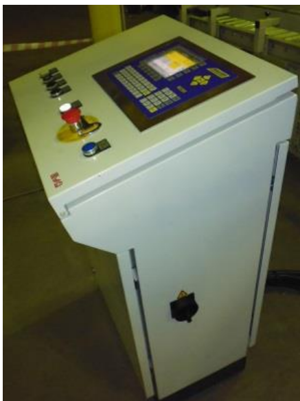
Рисунок 2 – Общий вид индикатора, встроенного в пульт управления оператора
