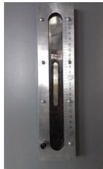
Рисунок 2 – Места пломбирования мерников металлических эталонных 2-го разряда M2p-2000
