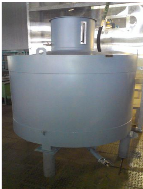
Рисунок 1 – Общий вид мерника металлического эталонного 2-го разряда М2р-2000
