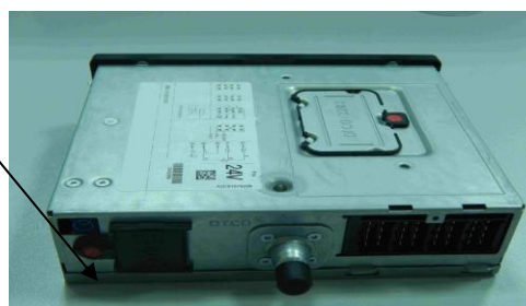
Рисунок 2 - Схема пломбировки от несанкционированного доступа
