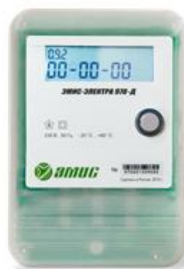
Дополнительное отсчётное устройство для счётчиков исполнения «С»
