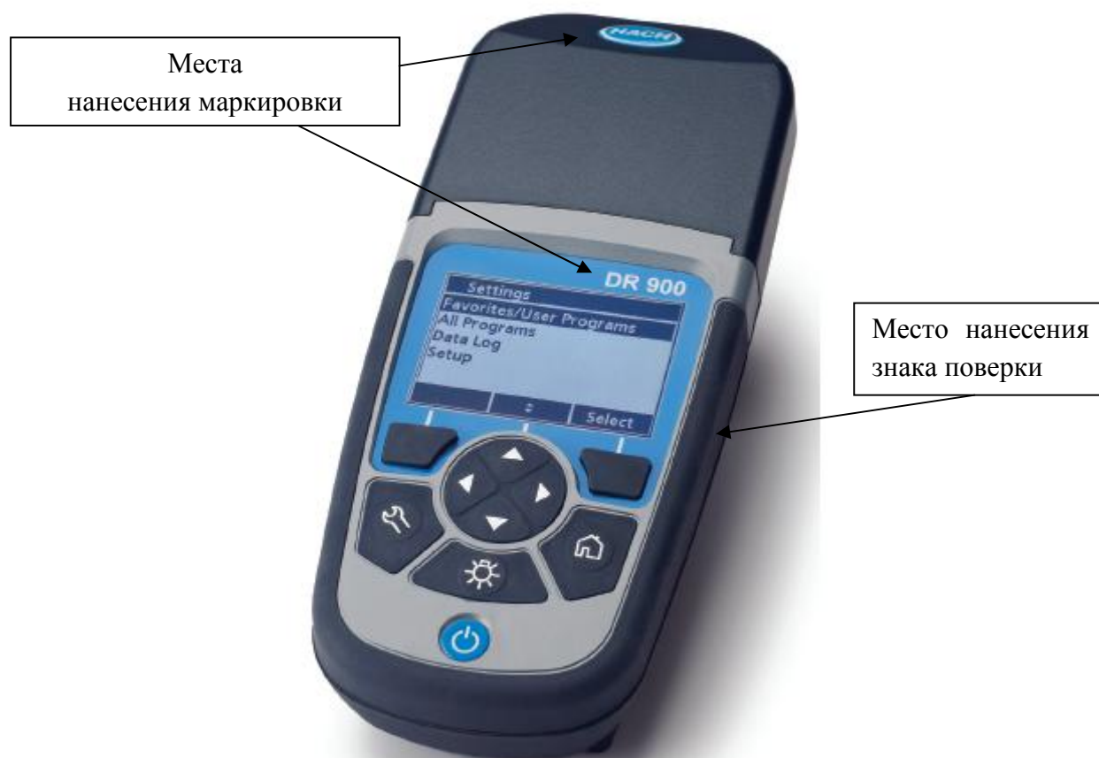
Рисунок 3 – Общий вид спектрофотометров DR 900 с обозначением мест нанесения маркировки и знака поверки
