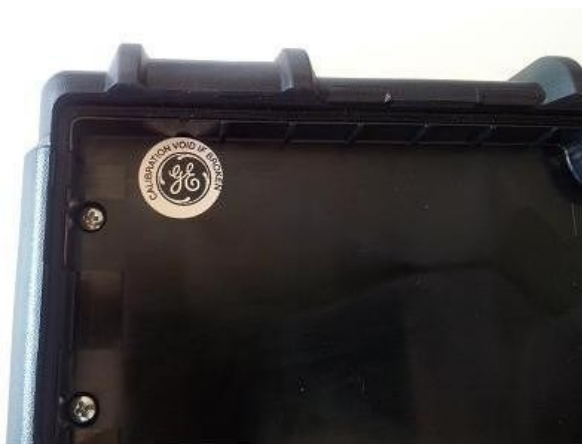
Рисунок 2 – Схема пломбировки электронного блока толщиномера от несанкционированного доступа
