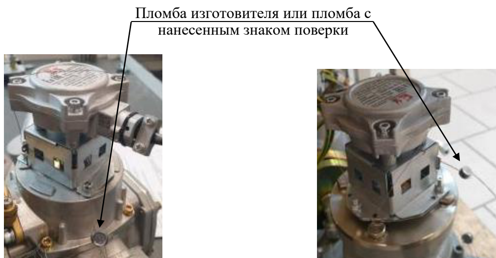
Рисунок 12 – Схемы пломбировки генераторов импульсов
