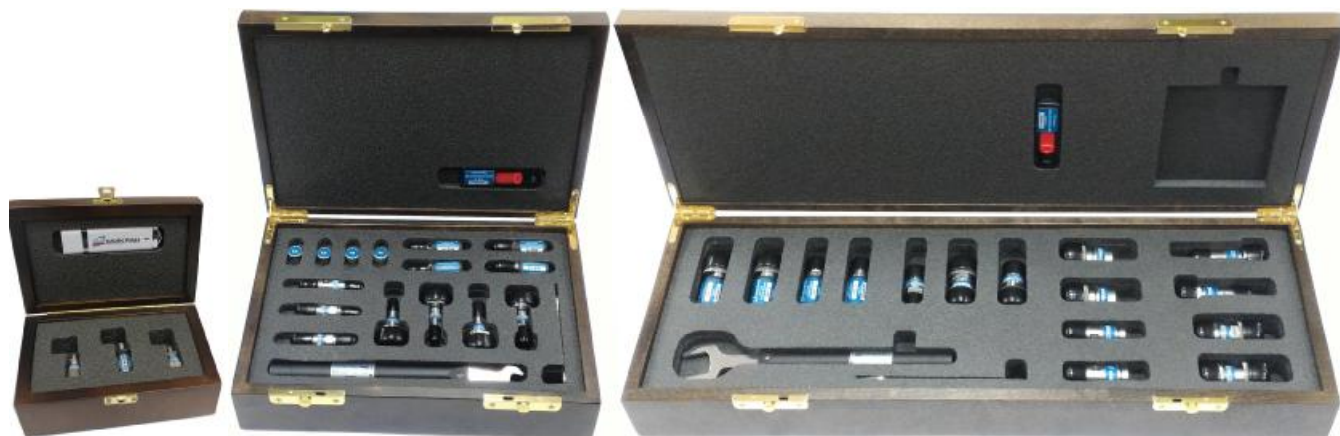
Рисунок 1 – Внешний вид наборов калибровочных мер НКММ в коаксиальных волноводах с диаметрами поперечных сечений 7,0/3,04 мм, 3,5/1,52 мм и 2,4/1,042 мм
