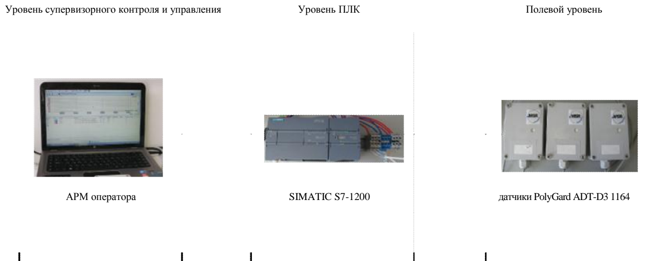
Рисунок 1 - Структурная схема системы газоаналитической Siemens с датчиками объемной доли двуокиси углерода PolyGard ADT-D3 1164
