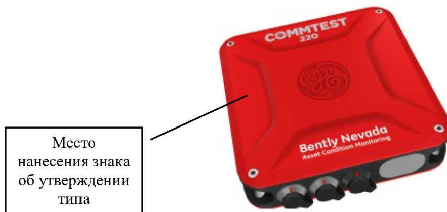
Рисунок 1 – Общий вид виброанализаторов портативных SCOUT220-IS и COMMTEST220
