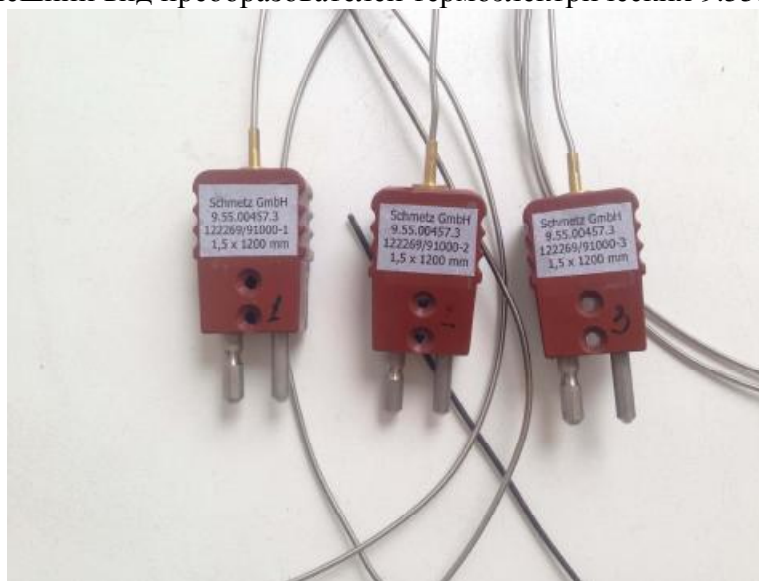
Рисунок 2 – Заводские номера и маркировка преобразователей термоэлектрических 9.55.00457.3
